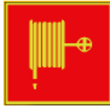
kuva 2: alkusammutuskaluston merkintätapoja (jälkivalaisevat kyltit)
